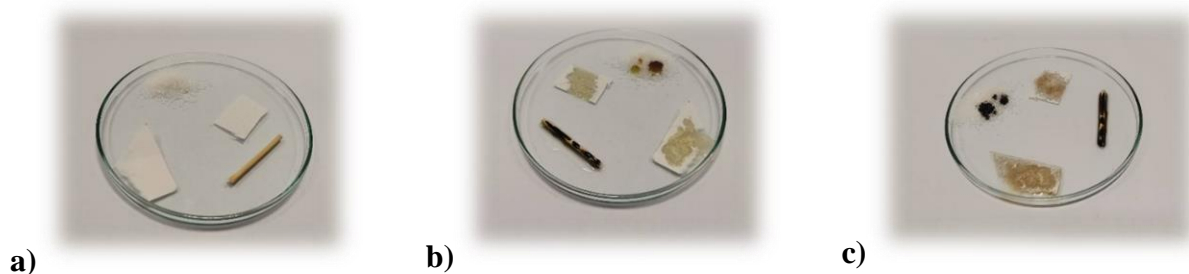
Obrázok 28. Dôkaz uhlíka: a) vzorky: cukor, špajdl'a, vreckovka, filtračný papier; b) pridanie kyseliny sírovej do vzoriek; c) vzorky po pridání kyseliny po cca 10 min.
