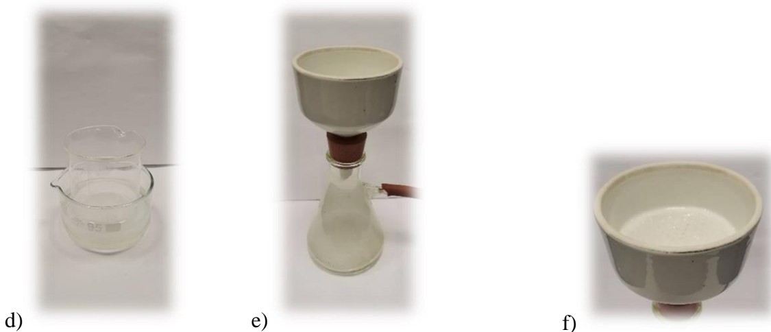
Obrázok 11. Kryštalizácia kyseliny benzoovej: a) zahrievanie kyseliny benzoovej vo vode k varu; b) jednoduchá filtrácia – ideálna; c) jednoduchá filtrácia – kryštalizácia v ústí lievika; d) chladenie v studenom vodnom alebo ľadovom kúpeli; d) filtrácia cez Büchnerov lieviku; e) detail na kyselinu benzoovú v Büchnerovom lieviku a sušenie.
