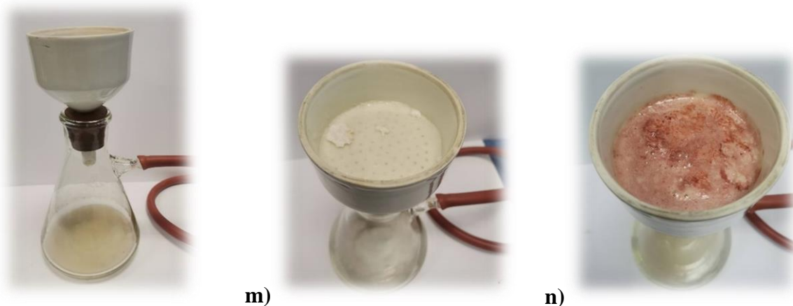
Obrázok 19. Extrakcia zmesi použitím kyslých a bázičských vodných roztokov: a) východiskové látky (kyselina benzoová a \beta -naftol); b) neznáma zmes látok; c) neznáma látka rozpustená v chloroforme; d) chloroformová vrstva v oddeľovacom lieviku; e) extrakcia chloroformovej vrstvy s 20 % vodným roztokom HCl; f) extrakcia chloroformovej vrstvy s 10 % vodným roztokom NaHCO 3 ; g) extrakcia chloroformovej vrstvy s 10 % vodným roztokom NaOH; h) chloroformová vrstva a vodné vrstvy 1, 2, 3 po extrakcii; i) stupnica pH – univerzálne indikátorové papieriky; j) vodné fázy – pH; k) neutralizácia vodných roztokov 1, 2 a 3 – vznik zrazenín; l) filtrácia cez Büchnerov lieviku; m) produkt po extrakcii – kyselina benzoová; n) produkt po extrakcii – \beta -naftol.
