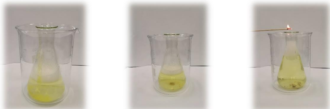
Obrázok 35. Dôkaz násobnej (trojitej) väzby: a) voda so saponátom v Erlenmeyerovej banke; b) prídanie \text{CaC}_2 ; c) priloženie tlejúcej špajdle.
