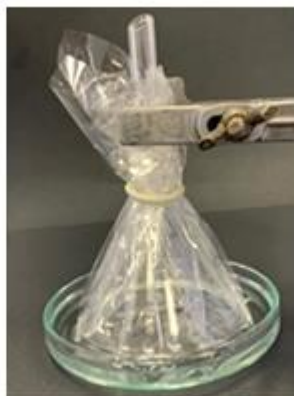
Petriho miska naplnená destilovanou vodou a lievnik v celofáne s obsahom vajcového bielka, roztoku NaCl a glukózy. Celofán predstavuje dialyzačnú membránu.
