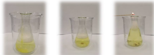
Obrázok 35. Dôkaz násobnej (trojitej) väzby: a) voda so saponátom v Erlenmeyerovej banke; b) prídanie \text{CaC}_2 ; c) priloženie tlejúcej špajdle.
